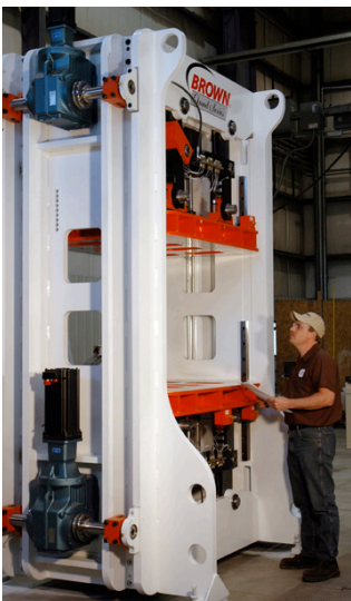
Estructura del Marco de alta Resistencia
