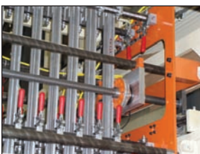
Sistema de Rueda "Servo NIP" con Guías de Lámina de Cambio Rápido
